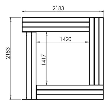
Béton : 0.48m³ 4 plots 0.50x0.60 prof 0.40M Finition: MM135D-Config D-LT Brut : Métalisée : Echelle: 1:30 Matière: Qté: Dessiné par: Romain.H Galvanisée: Poids: 433.65 kg Format: A4 Date: 14/11/2024 Thermolaquée : Ce plan est la propriété de MKUBE. Il ne peut être reproduit ni modifié sans autorisation. RAL: Page: 2/2 Emplacement fichier: C:\Users\rhimber\Documents\PLANS\Mobiliers urbains\MM135-KU
