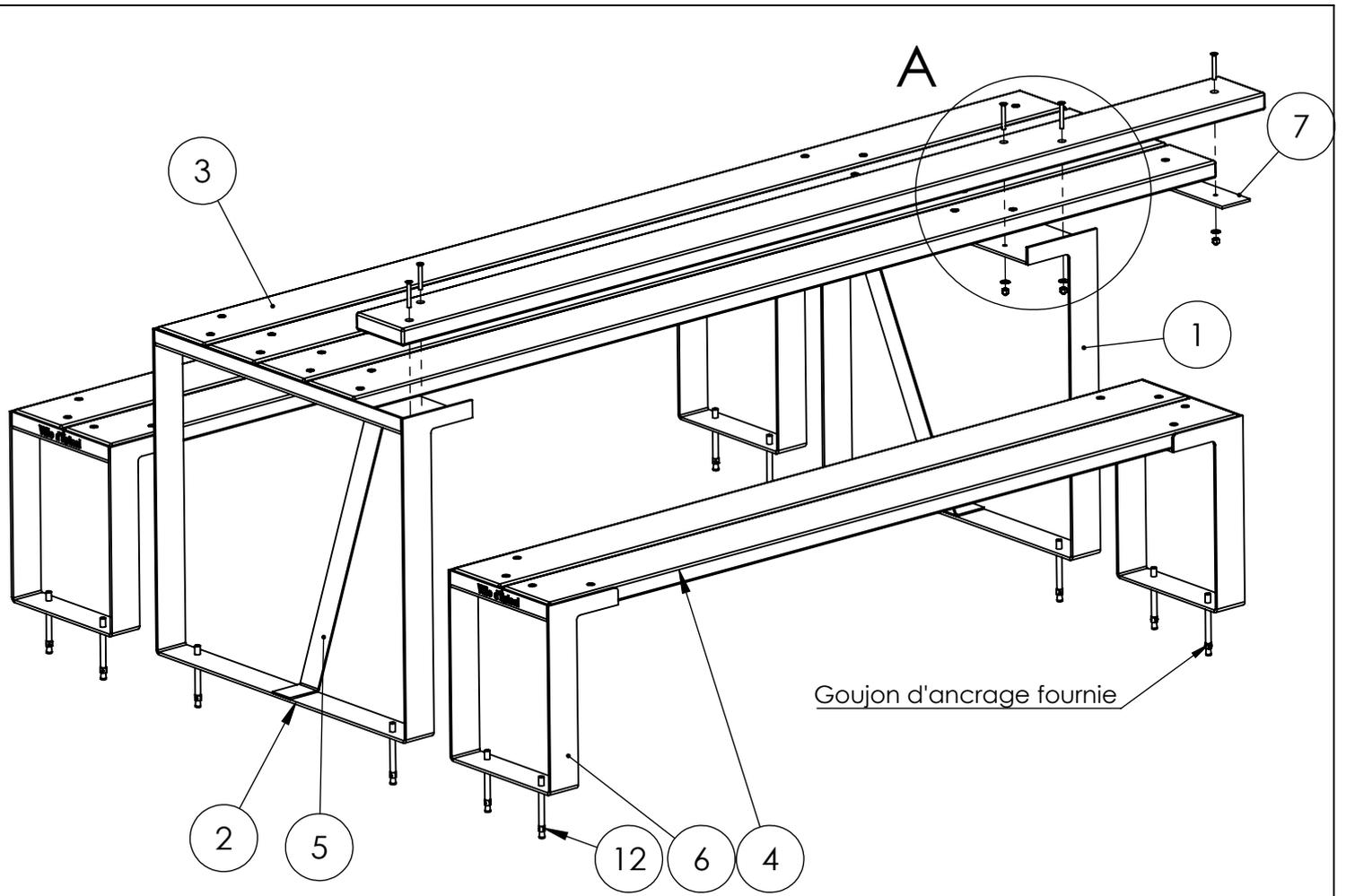
Assemblage des pieds et dossier par boulonnerie inox
