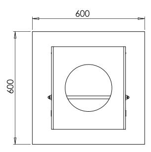
Plot béton: 0.08m³
