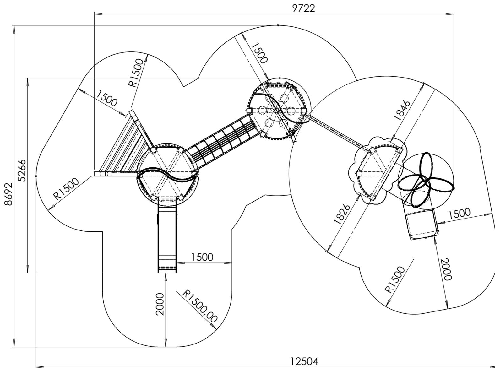
Structure bois en pin classe 4 section 120x120
